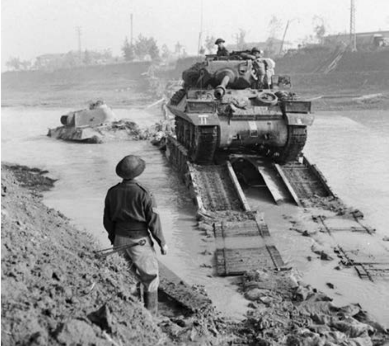
24 ottobre 1944. Un Tank Destroyer Achilles del 93° Anti-Tank Regiment attraversa il fiume Savio sopra un Churchill ARK posizionato nel fiume (si nota sullo sfondo un carro tedesco Panther oramai abbandonato in acqua).
